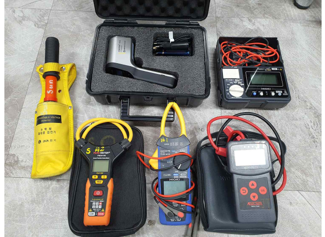
절연저항측정기 및 기타: TK4003, SK7020S, HIOKI IR4051, 배터리측정기, 전류계 등
