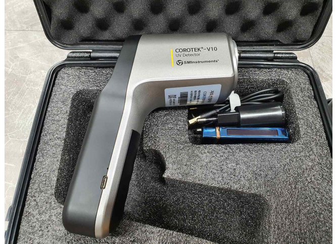
코로나 방전 UV 측정: COROTEC-V10
