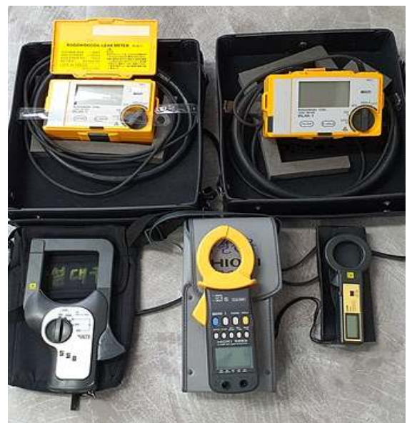
누설전류계: 멀티 RLM-1, 멀티 MCL-800D, 이오키 3283, 멀티 LEAKER 140
